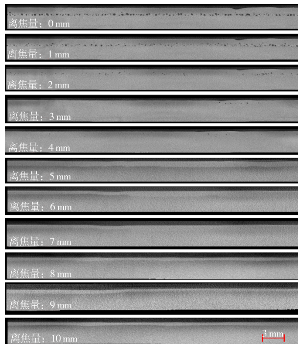
图5 不同激光离焦量下环焊缝纵截面气孔分布
